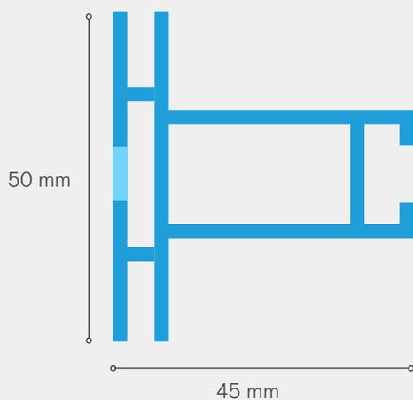
Le DS-50 est un profil en aluminium à deux faces, basé sur un cadre autoportant de 50 x 45 mm, servant à tendre une toile imprimée à l'aide d'une bandelette en silicone (tendon). Le côté du profilé peut être pourvu d'une fente pour fixer des câbles de suspension coulissants ou des pieds. Pour des cadres dépassant 2 mètres, des profilés de renforcement sont systématiquement prévus. On obtient un écran acoustique Ilex en remplissant le cadre de matériau absorbant le son.
